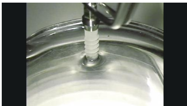
図4：UVC照射による能力を失うとインプラント体は疎水性になる。
