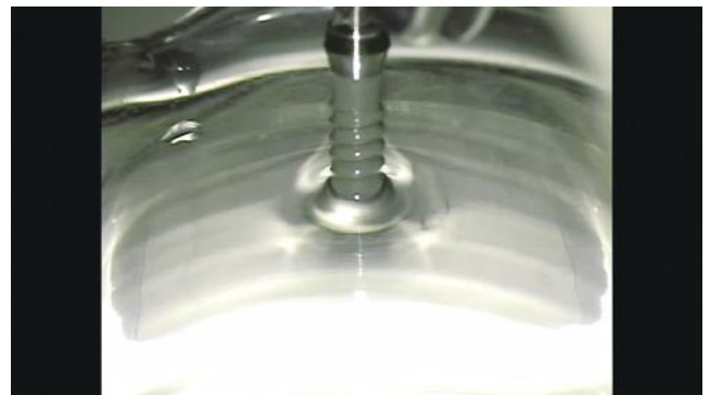
図1：インプラント先端から精製水が上昇している様子。
